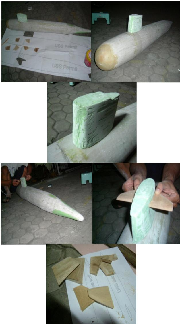
Gambar 8. Model USS Permit, model Bare Hull Midget, kombinasi Hull Conning Tower, bagian buritan model kapal selam, model *hydroplane* haluan, bahan dasar model *appendices* dari kayu sebelum dilapisi *fibreglass*.
