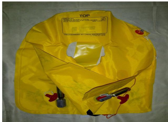
Gambar 6. Tuas/handle penarik tabung CO<sub>2</sub> agar *lifevest* mengembang
