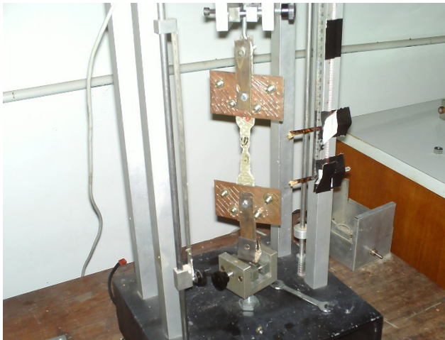
Gambar 2. Alat uji yang digunakan untuk pengujian tarik ( tensile )
