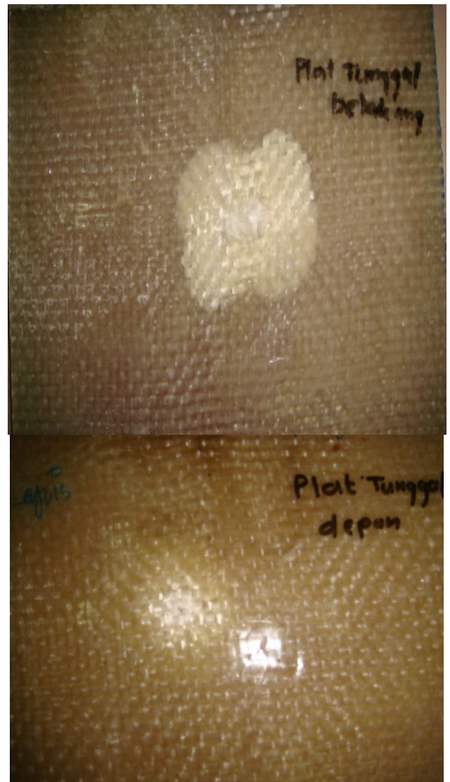
Gambar 1. Uji balistik terhadap spesimen panel tunggal yang tembus (tampak belakang dengan diameter terang lebih besar dibandingkan dengan tampak depan).
