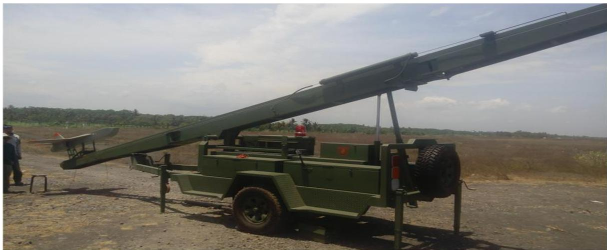
Gambar 4. Launcher yang digunakan untuk Rudal Petir
