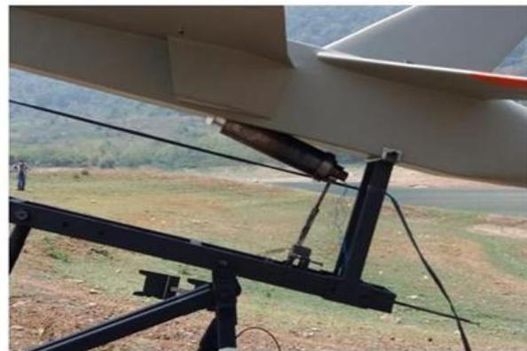
**Gambar 24.** Pemasangan *booster* pada saat uji terbang di wahana *dummy* Rudal Petir
