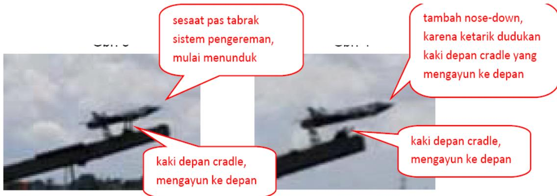
**Gambar 6.** Hasil pengawasan *attitude* rudal saat keluar dari *launcher*
