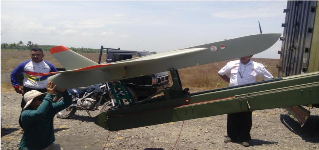
**Gambar 15.** Pengujian *launcher* untuk digunakan oleh Rudal Petir
