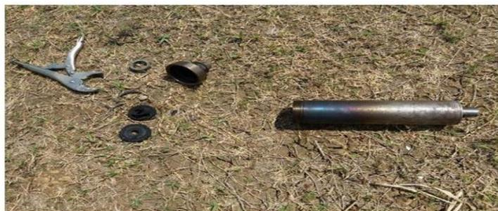
**Gambar 20.** Hasil penyalan *booster* motor roket (kiri) dan kondisi komponen motor roket setelah habis pembakaran propelannya (kanan)
